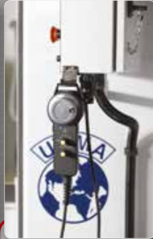
Electronic handwheel to move axis. Elektronisches Handrad für die Bewegung der Achsen.
