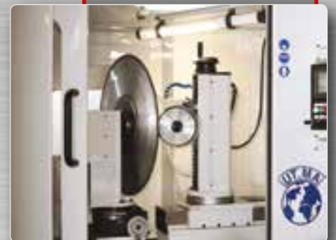
AC 800 Schleifung von Rundmesser bis Durchmesser 800 mm.
