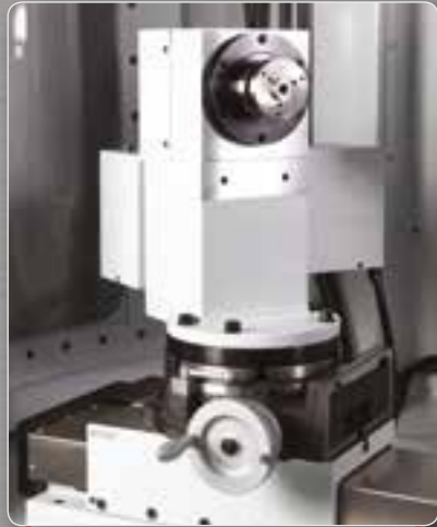
Turning table to tilt knife head. Tisch drehbar für die Neigung des Messerkopfes.
