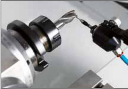
Schleifscheibenkopf Drehung CNC gesteuert, option 4 gesteuert Achsen mit Drehung des Schleifscheibenkopf manuell.
