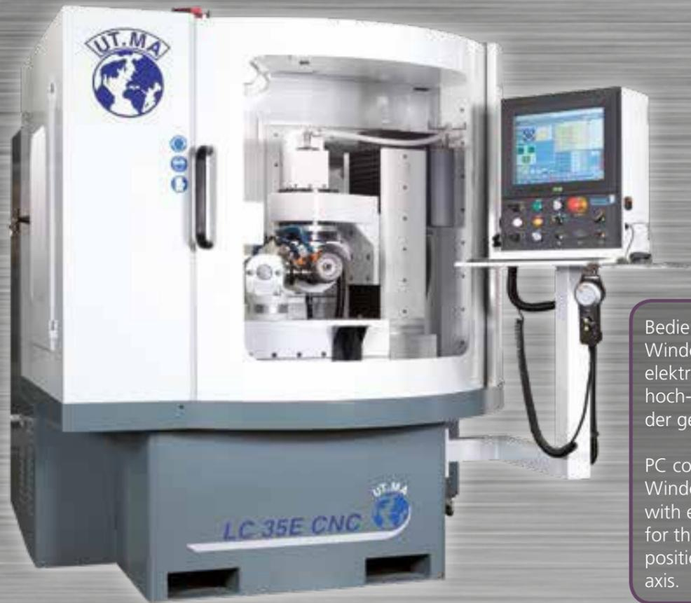
Bedienpaneel mit PC und Windows Software und elektronisches Handrad für die hoch-präzision Positionierung der gewählten Achse.
