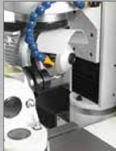
Nut Schleifung einer Spiralfräser.
