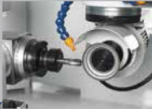
Schleifung einer Linearfräser.
