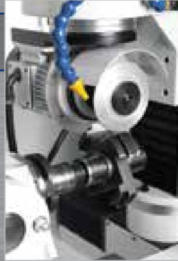
Aussenschleifung einer Spiralfräser.
