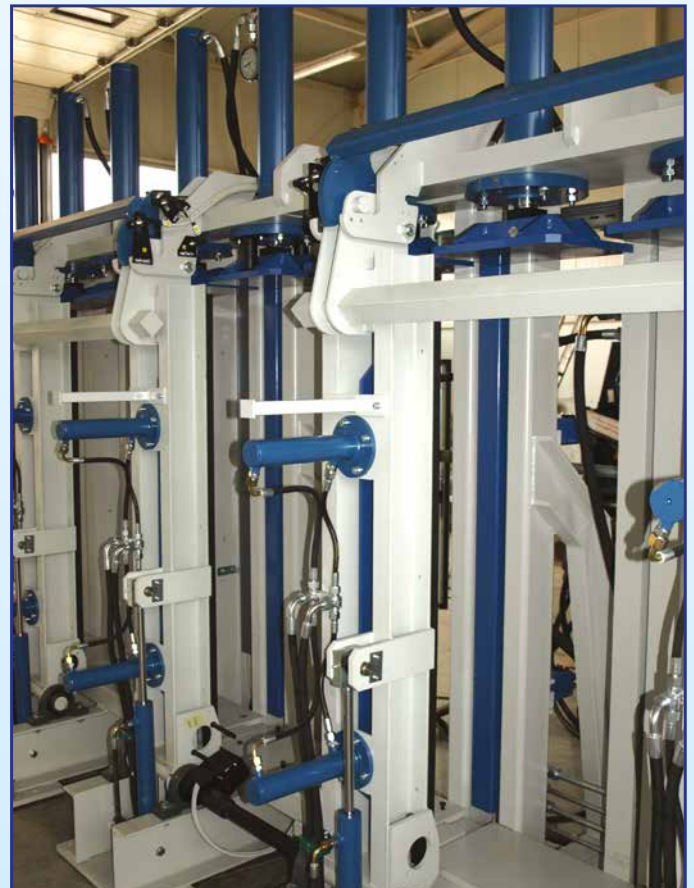
Straightening cylinder in front side, movable supports rear Ausgleichzylinder vorne, verstellbare Anschläge hinten Cilindri di accommodamento frontali, guide mobili posteriori Cylindre de raccomodement avant, appui mobile arrière Cilindros de arreglo en la parte delantera, superficie móvil de apoyo en la parte trasera
