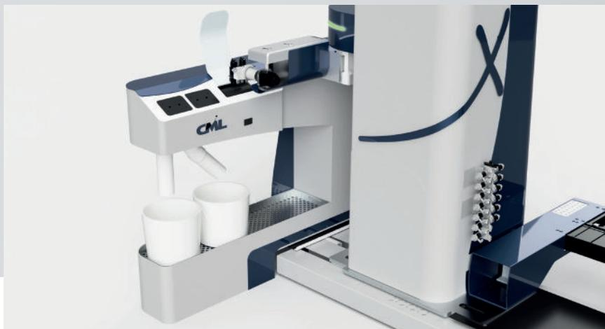
"Smart Box" per pulizia automatica testa di spruzzatura e valvole di cambio colore
