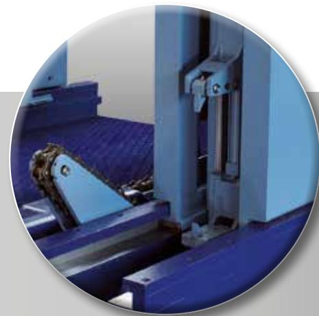
Ausführung mit festen Klauen, die von einem ölhdraulischen Doppelzylinder angetrieben werden und deren Vorsprung sich mit gusseisernen Anschlagplatten in 4 Positionen einstellen lässt.
