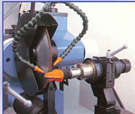
Profilatura punte da pantografo Routerbit profiling Affutage des meches de défonceuse Profilierung von Profilschaftfräsern
