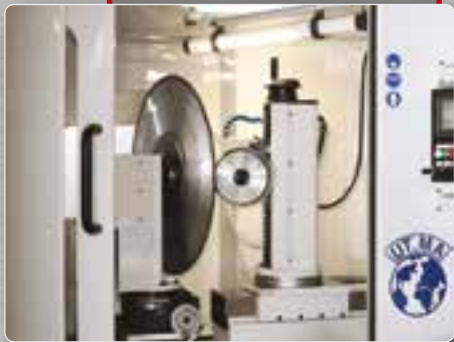
AC 800 Schleifung von Rundmesser bis Durchmesser 800 mm.
