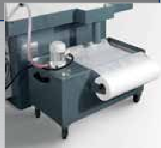
Kühlmittel tank mit Papierbandfilter. Coolant tank with paper filter.
