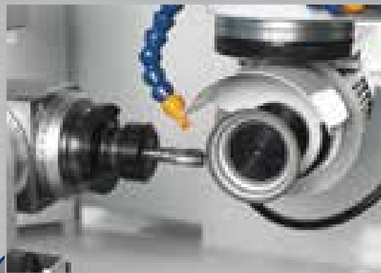
Aussenschleifung einer Spiralfräser. Helical tool - external grinding.
