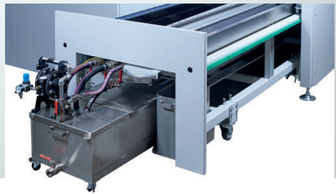
Lackrückgewinnungs- und Bandreinigungseinheit mit durchdachten Detaillösungen.
